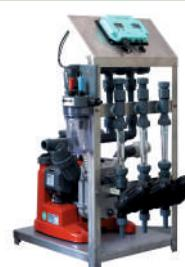
**Автоматические узлы внесения удобрений** – это стенды для внесения маточных растворов и кислот по заранее составленной программе. Позволяют дозировать несколько видов удобрений в объёмном соотношении, регулировать скорость поступления каждого из них в автоматическом режиме. Расходомеры, датчики pH и EC дают возможность контролировать параметры приготовляемого раствора и сохранять данные для последующего анализа.
