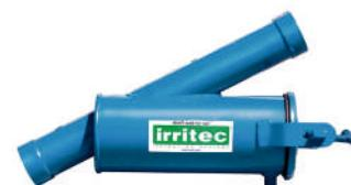
**Сетчатый фильтр с полуавтоматической промывкой** – для очистки поливной воды от механических примесей, как основной или контрольный фильтр. Промывка производится вручную без остановки работы системы орошения, но требует участия рабочего персонала.
